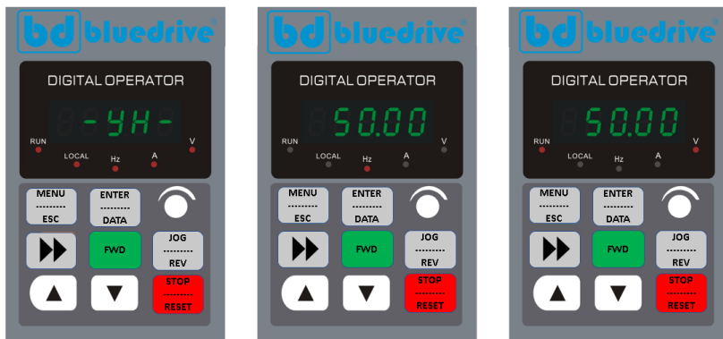
Fig. 4-4 Exibição do parâmetro de inicialização, monitoramento em funcionamento e parado
