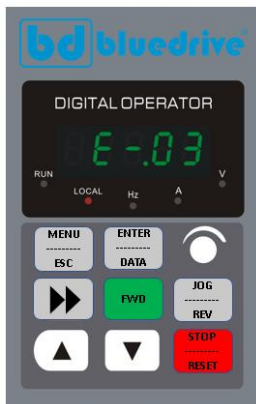
Fig. 4-5 Modo de exibição de alarme ou falha
