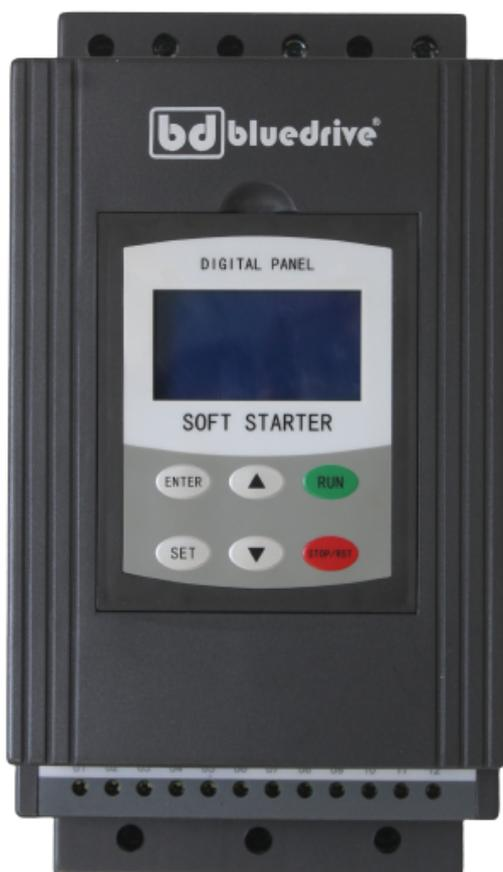
A linha de Soft-Starters BD5000 atende as aplicações que buscam otimizar e suavizar a partida de motores elétricos com baixo custo, onde não exige o controle da velocidade, reduzindo assim os picos de corrente e os esforços mecânicos durante a partida dos motores. Com sua tecnologia de By-pass externo, possibilita realizar partida de vários motores em modo cascata, otimizando ainda mais sua funcionalidade.
