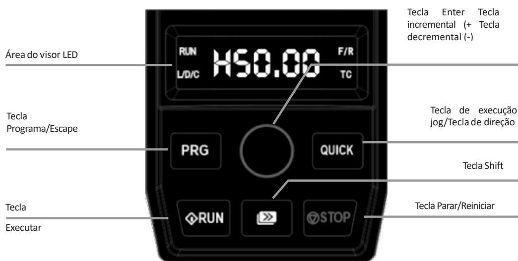
Figura – Painel de operação com display digital LED integrado (configuração padrão, não removível)
